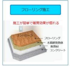
・フロア:8mm · 木綿網発熱体: 0.8mm (エンドレスドリーム) · 断熱材:5mm
